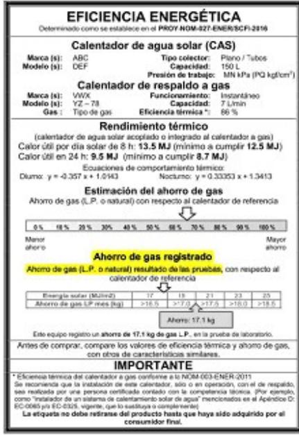
Figura 1 - Ejemplo de distribución de la información de la etiqueta para calentadores de agua solares con o sin respaldo.
