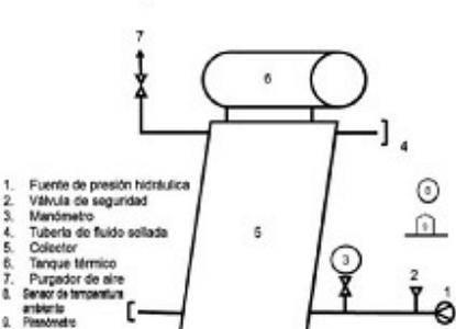
Figura A.11 - Resistencia al sobrecalentamiento
