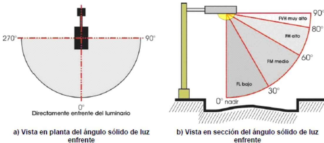
**D.5.4. Medición del flujo luminoso de deslumbramiento para luz atrás (B) o lado casa**
