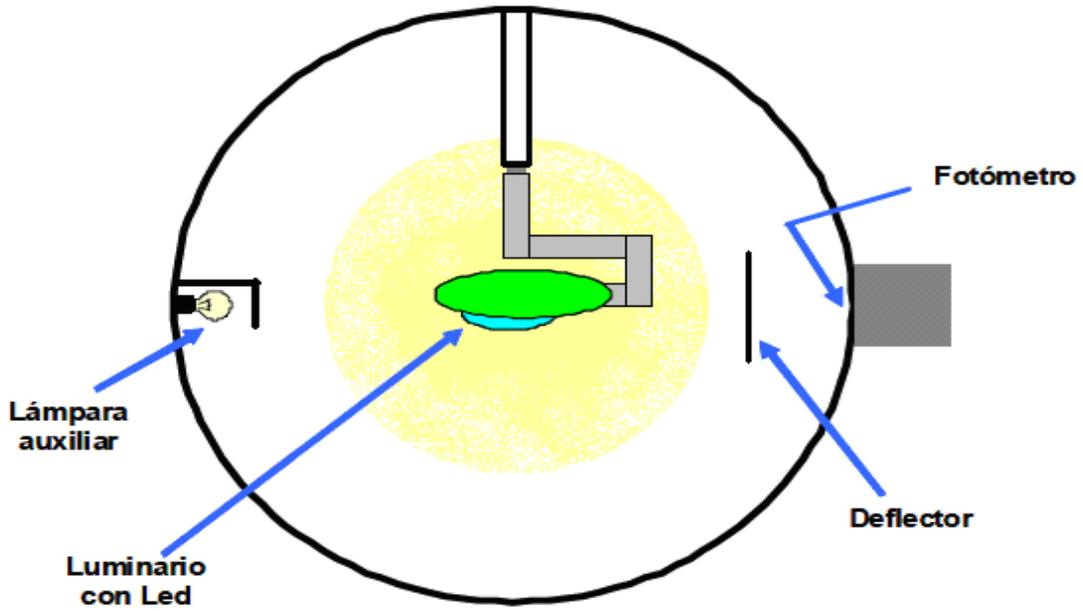
Figura F2. Configuración de la esfera integradora 2  $\pi$
