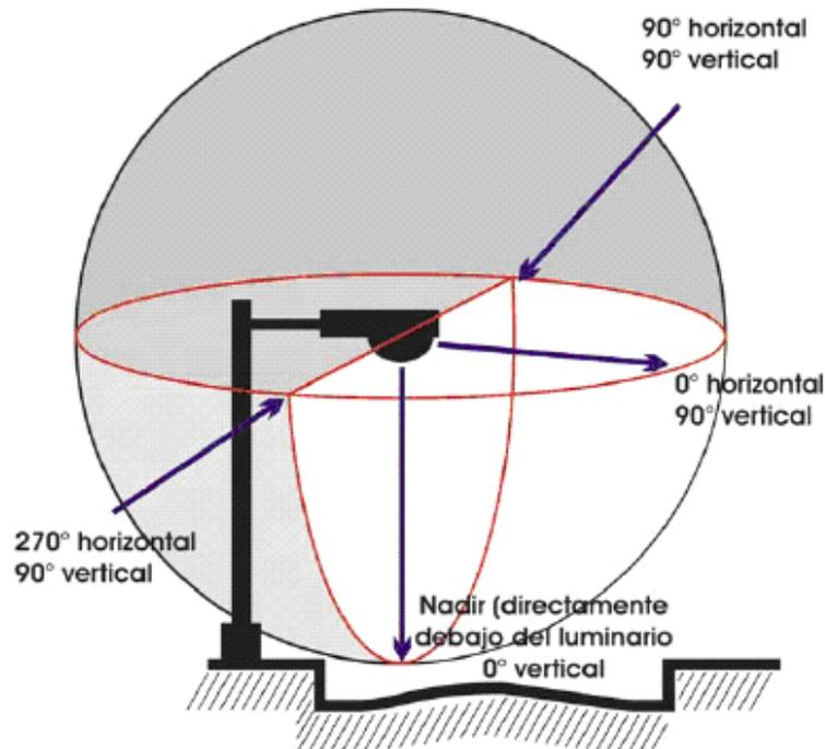
**D.5.3. Medición del flujo luminoso de deslumbramiento para luz enfrente (F) o lado calle**
